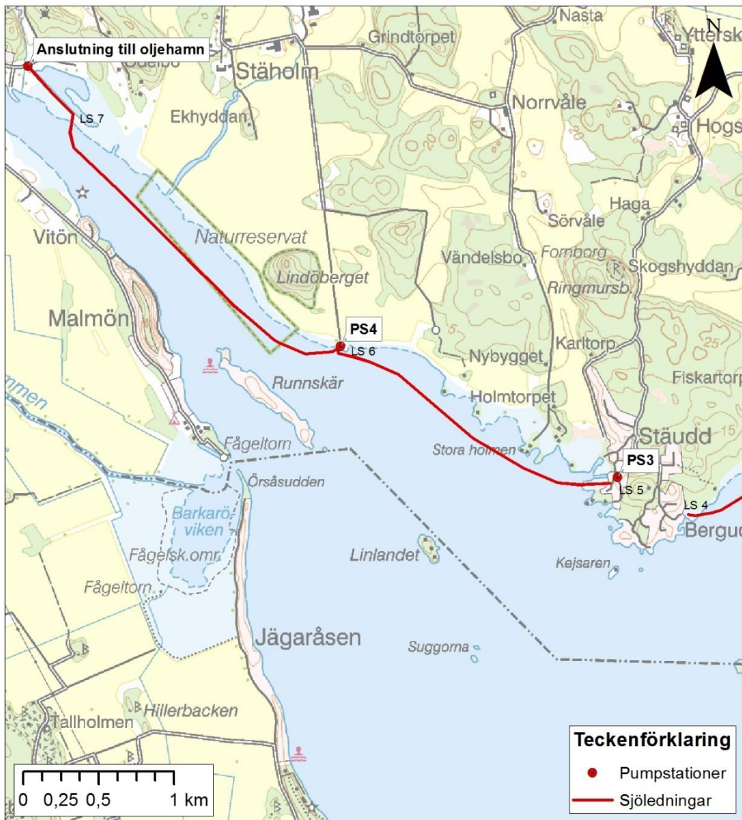
Figur 2. Västra delen. Ungefärlig sträckning av sjölédning visas som röd linje samt planerade pumpstationers ungefärliga lägen. Landstigningarna är numrerade och benämns LS1-LS7.
