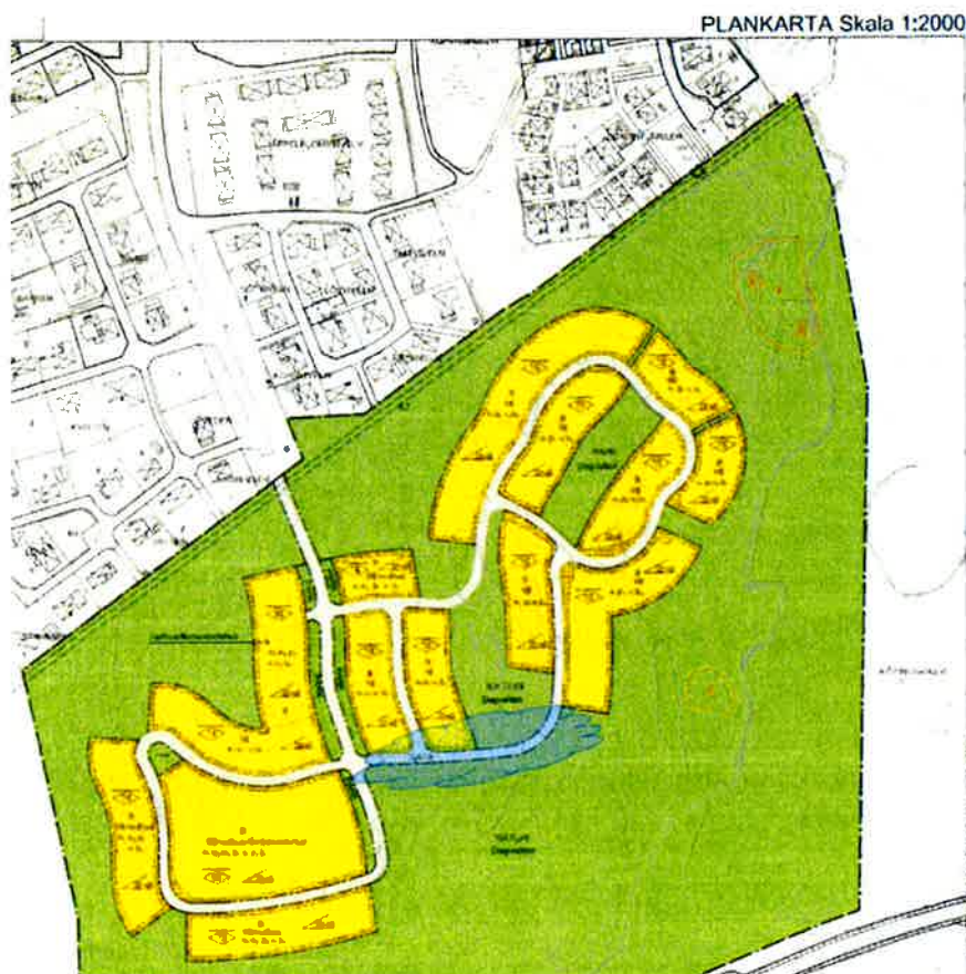
Figur 1. Nätstation för framtida försörjning av östra delen av Skogsleden. yta för nätstationen är setts lämpligen inom det blåa molnet.
